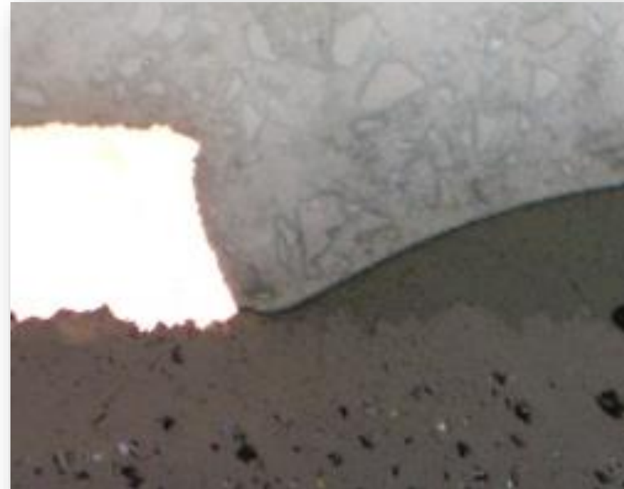
Prozessbedingt kein „Hinterschnitt“ möglich
