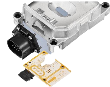
Beispiel: Abstandsradar Entwärmung eines HF-Layouts (77 GHz) mittels Dickkupfer-Technologie: Chip wird in einer Kavität platziert
